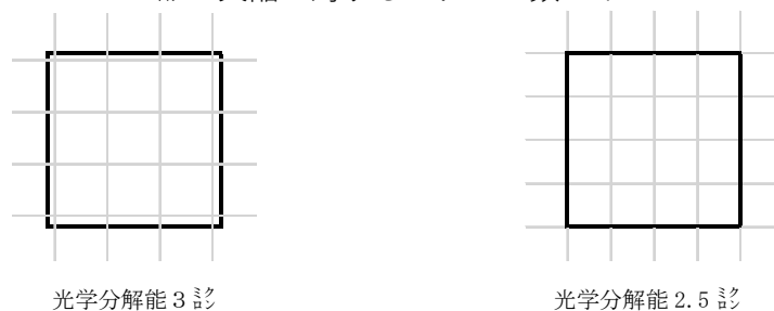
10 \times 10 \mu mの欠陥に対するピクセル数のイメージ
