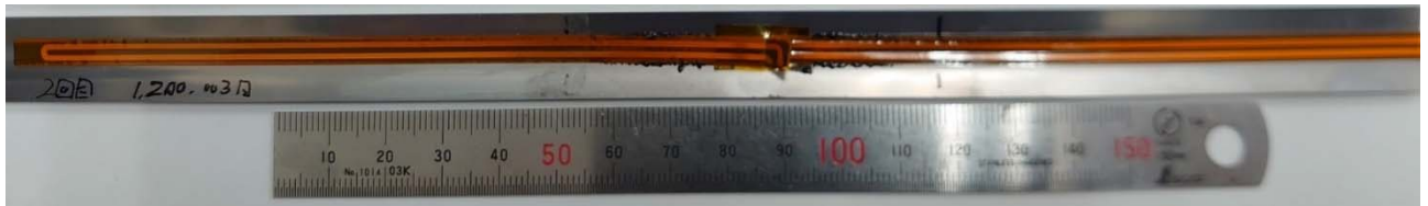
摺動試験後外観
